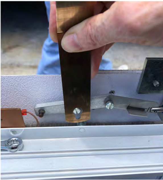
1. Unhook steel spring strap.
